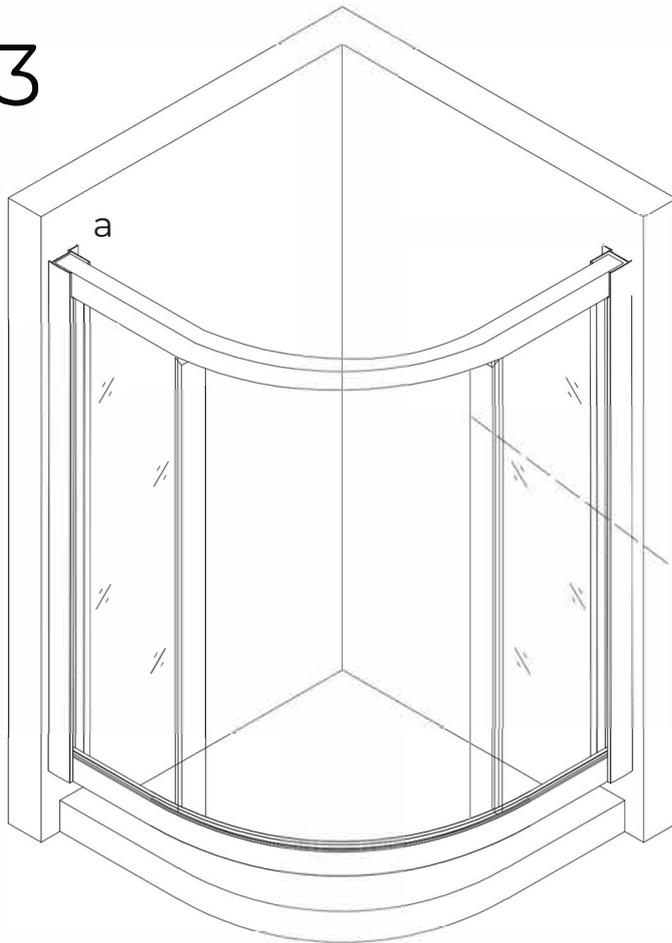
Uwaga: W celu dostosowania rozmiaru kabiny (zakres regulacji wynosi 0-10 mm na stronę) należy poluzować P01 na górnej oraz dolnej prowadnicy.
