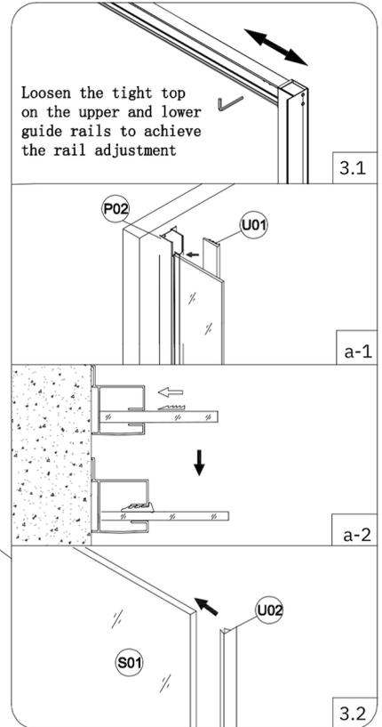
Uwaga: Uszczelkę U01 należy zamontować po skręceniu konstrukcji z elementów P01, P02, P03 oraz S01
