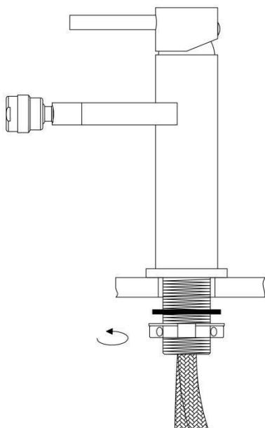
4. Na gwintowanej rurce montażowej dokręcić nakrętkę. Wyrównać i dokręcić baterię. Dokładnie sprawdzić montaż oraz szczelność baterii.
