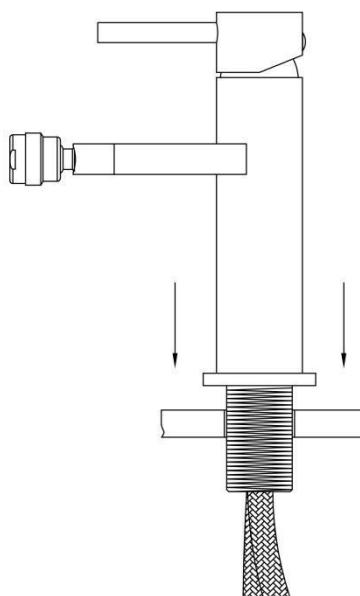
3. Zamontować dolną uszczelkę oraz podkładkę mocującą na gwintowanej rurce montażowej.
